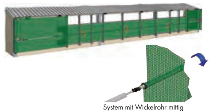
System mit Wickelrohr mittig
