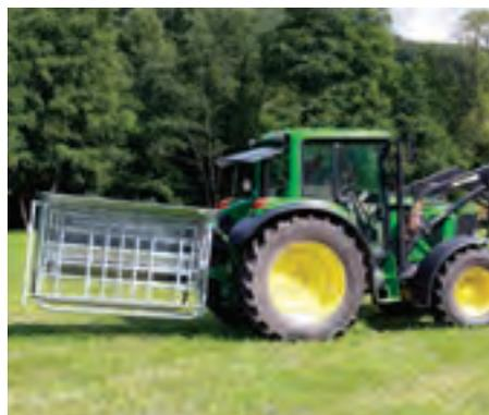
Transport über Dreipunkthängung mit beigeklapptem Kälberschlupf.
