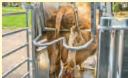
Rücklauf Sperre und Hinterfußwinde
