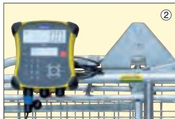
**!** Für den Umbau auf ein elektronisches Wiegesystem muss der Umbausatz sowie eine Wiegezelle und eine Anzeigeeinheit bestellt werden.
